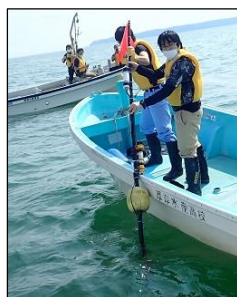
スマートブイの設置作業
